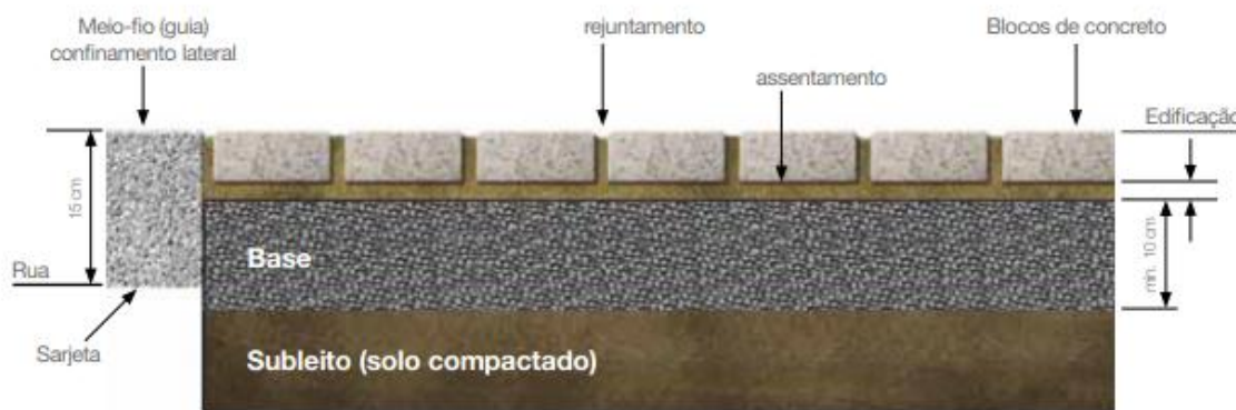
Figura 05: Estrutura Típica do pavimento em concreto intertravado
